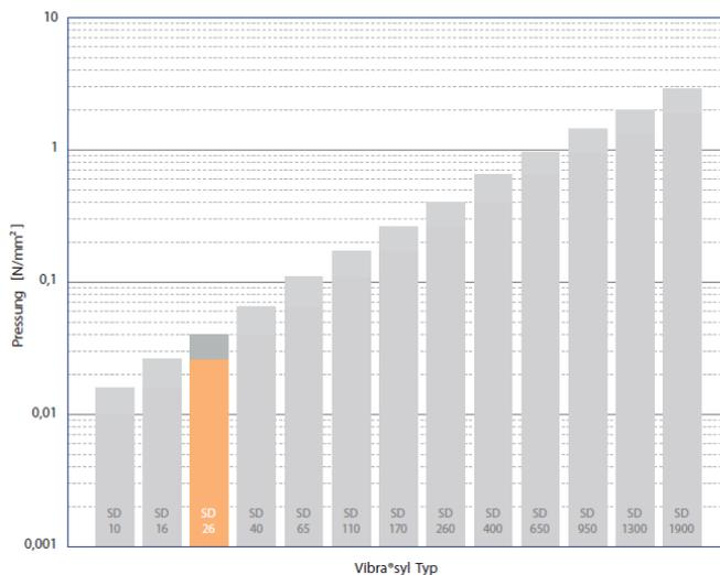
Statische Dauerlast: bis [N/mm<sup>2</sup>]
