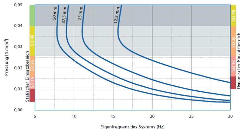
Eigenfrequenz eines Systems, bestehend aus einer kompakten Masse und einer elastischen Lagerung aus Vibra<sup>®</sup>syl SD 26 auf starrem Untergrund.
